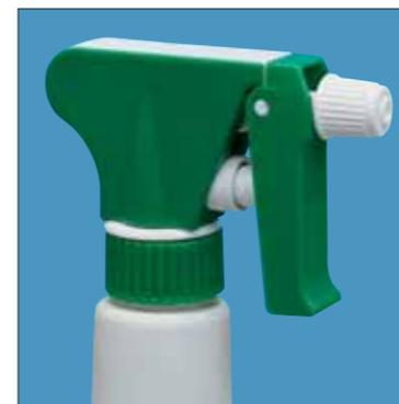
Die SPRAY 90G ist eine transportgesicherte Sprühpistole mit Düse justierbar vom direkten Strahl bis zu feinem Nebel, geeignet für Insektizide, Pflanzen- und Autopflegeprodukte. Die dekorative Verkleidung ist in einer Vielfalt von Farbkombinationen lieferbar. Ausbringungsrate von 0,9 ml per Hebeldruck. Die SPRAY 90 ist technisch dieselbe Sprühpistole, aber ohne Verkleidung und daher preisgünstiger.
