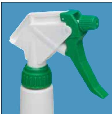
Die MAXI T/N ist eine transportgesicherte Ausführung der Maxi, entworfen zur Montage auf gefüllte Flaschen. Sie bietet eine sehr hohe Ausbringungsrate von 2,5 ml je Hebeldruck. Die Düse ist endlos verstellbar, von Strahl bis zu feinem Nebel. Die Maxi T/N hat eine sehr robuste Ausführung und eignet sich für den Gebrauch mit fertigen Produkten wo eine große Menge versprüht werden muß. Ein Originalitätsverschluß an dem Hebel bricht bei der ersten Betätigung ab.
